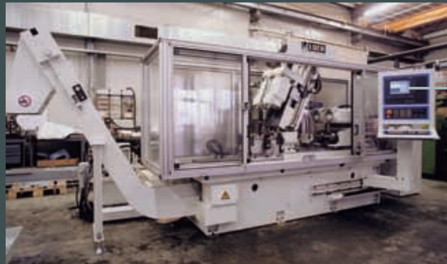
Tiefbohranlage TBA 1-4/E-600/2-2 4-spindlige Tiefbohranlage zum Bohren von Nockenwellenlagergehäusen
