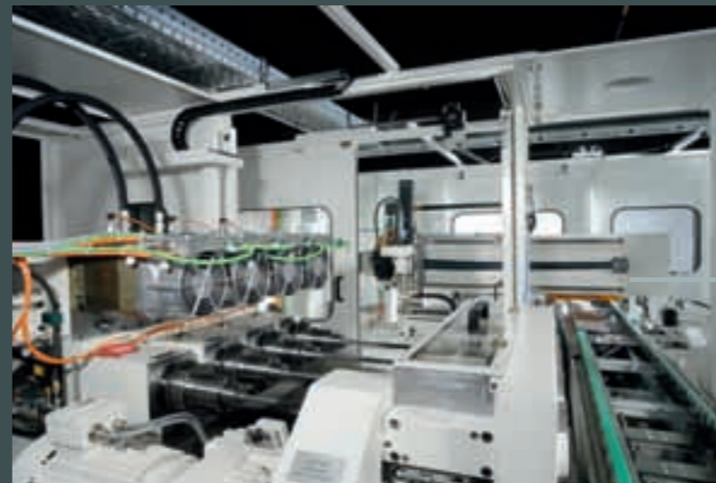
Tiefbohranlage TBA 1-6/E-400/4+4 GK zum 8-spindligen Tiefbohren, Aufbohren, Gewinden, Querbohren und Auskammern von Getriebewellen
