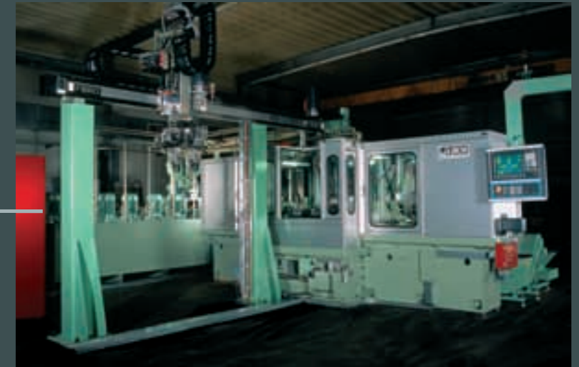
Tiefbohranlage TBA 1-222-300/2-3 Tiefbohranlage mit 3 2-spindligen Einheiten zur Bearbeitung von Getriebewellen
