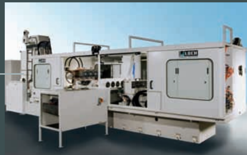
Tiefbohranlage TBA 1-6/E-500/4 BRS 8-spindlige Tiefbohrmaschine zur Bearbeitung von Getriebewellen, zusätzliche Station Aufbohren, Gewin- den, Querbohren und Reiben enthalten
