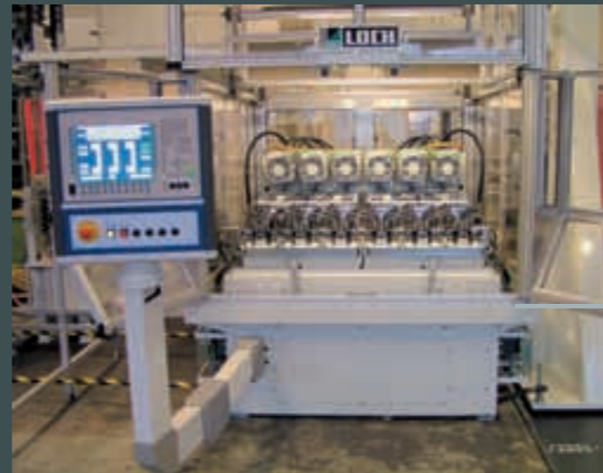
Tiefbohranlage TBA 1-5/E-150/6 6-spindlige Tiefbohranlage zur Bearbeitung von Pleuel
