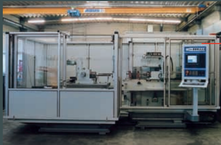
KTB 1-5 / 12-05-12 / 05 CNC Tisch Längshub 500 mm Querhub 1200 mm Einheit Vertikalhub 500 mm Bohrhub 1200 mm Bohrbereich \varnothing 3-25 mm ins Volle
