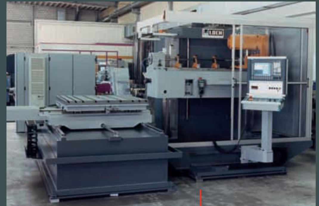
KTBF 1-6 / 12-10-12 / 05 Tisch Längshub 500 mm Querhub 1200 mm Einheit Vertikalhub 1000 mm Bohrhub 1200 mm Bohrbereich \varnothing 3-30 mm ins Volle inkl. separater Frässpindel
