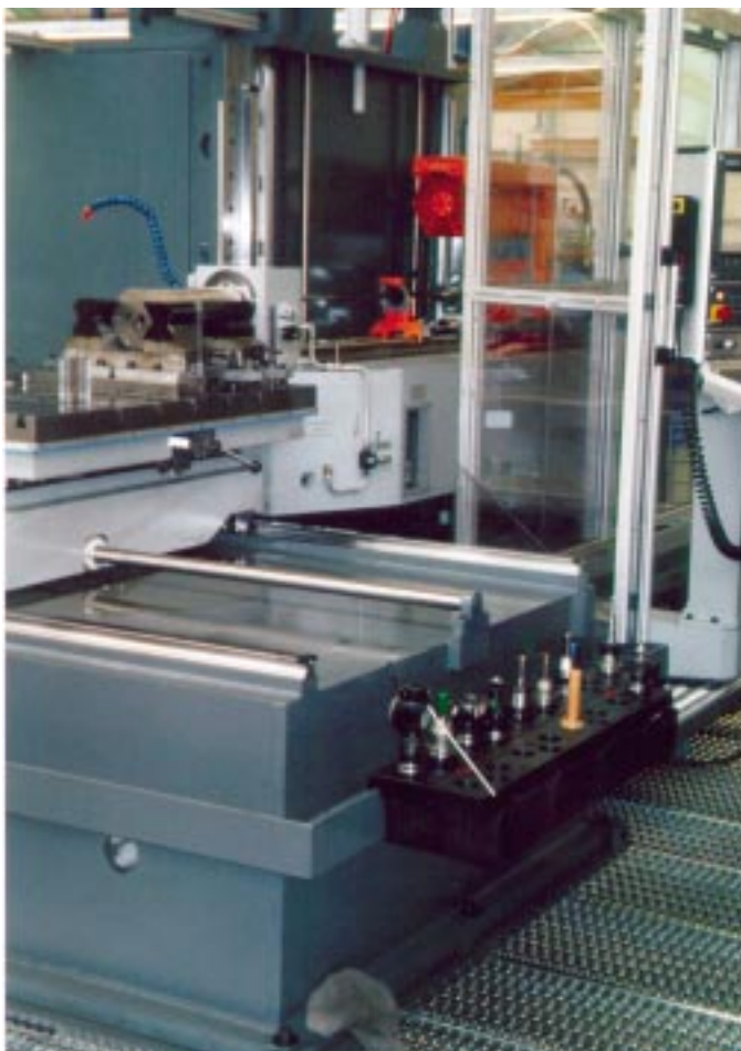
Stabile Schweißkonstruktion mit großem Arbeitstisch und Vertikalbewegung in der Bearbeitungseinheit; im Vordergrund Werkzeuge für die Frässpindel
